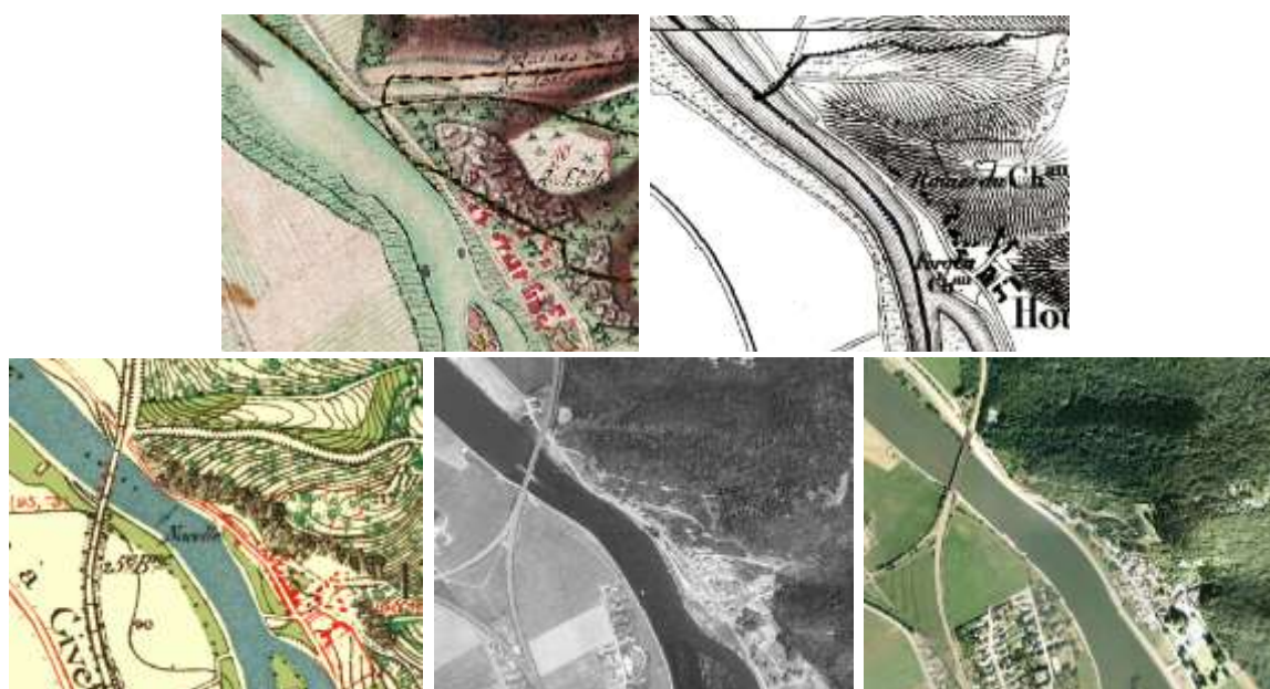
Figure 35. En 1770-1778 (carte de Ferraris) et 1846-1854 (carte de Vandermaelen), rien sur la Meuse à cet endroit. En 1865-1880 (carte du dépôt de la guerre) le pont ferroviaire (ou pont-rail) en poutre en treillis sans raccordement supérieur et à tablier inférieur, en acier, sur trois piles, continue la ligne vers Dinant. En 1971, on voit la ligne vers Warnant. En 1994, la route a été élargie en raccord avec le nouveau pont d'Yvoir. © geoportail.wallonie.be
